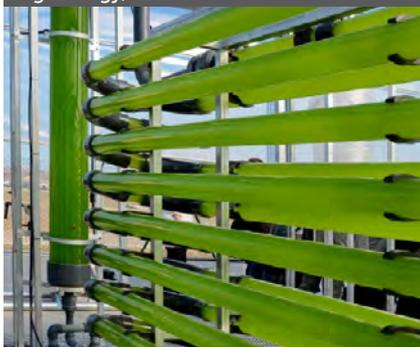
Figura 46. Fotobiorreactor Tubular Cerrado. Plataforma Tecnológica de Experimentación con Microalgas (PTM). AlgaEnergy, S.A.
