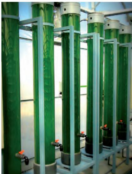
Figura 49. Cultivo de microalgas en columnas de burbujeo de 0,1 m<sup>3</sup> volumen unitario, ubicadas en la PTEM.
