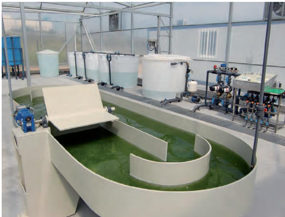
Figura 48. Reactor Raceway. Plataforma Tecnológica de Experimentación con Microalgas (PTEM). AlgaEnergy, S.A.
