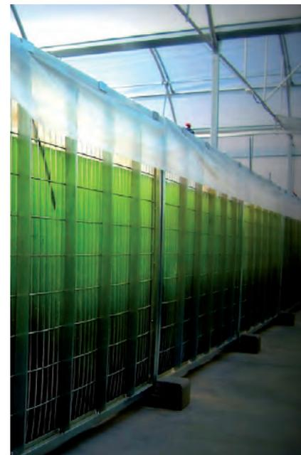
Figura 47. Fotobiorreactor Vertical Plano. Plataforma Tecnológica de Experimentación con Microalgas (PTEM). AlgaEnergy, S.A.
