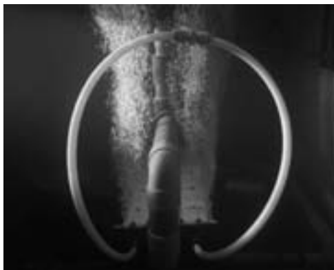
Figura 1. Difusor de aire patentado para aplicaciones en acuicultura y depuración de aguas
