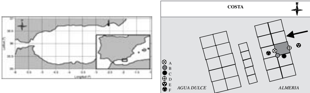
Figura 1. Localización geográfica y configuración de la instalación (jaula monitorizada sombreada y puntos que señalan las posiciones de los correntímetros, flecha negra señala la dirección predominante de la corriente).
